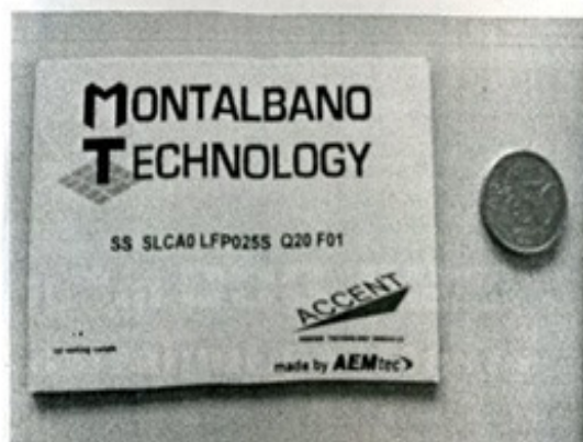
Le dimensioni di un'etichetta "intelligente" messe a confronto con una moneta: nello spazio di una carta di credito è possibile immagazzinare tutte le variazioni di temperatura cui il prodotto è stato sottoposto
